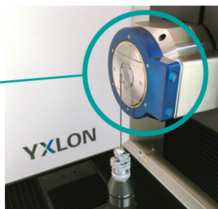
150nmのギャップを検出 (FF20 CTの透過型190kVマイクロフォーカスX線管で撮影)
